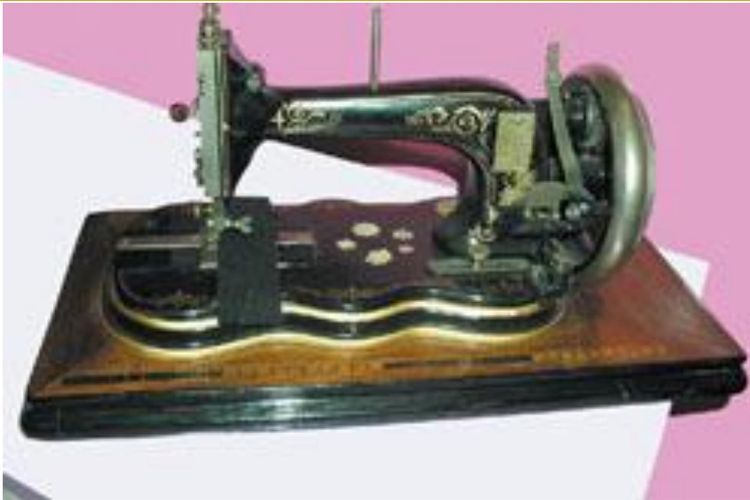
Одна из первых швейных машин челночного стежка фирмы "Зайдель и Науманн" (Германия, 1870-1880).
