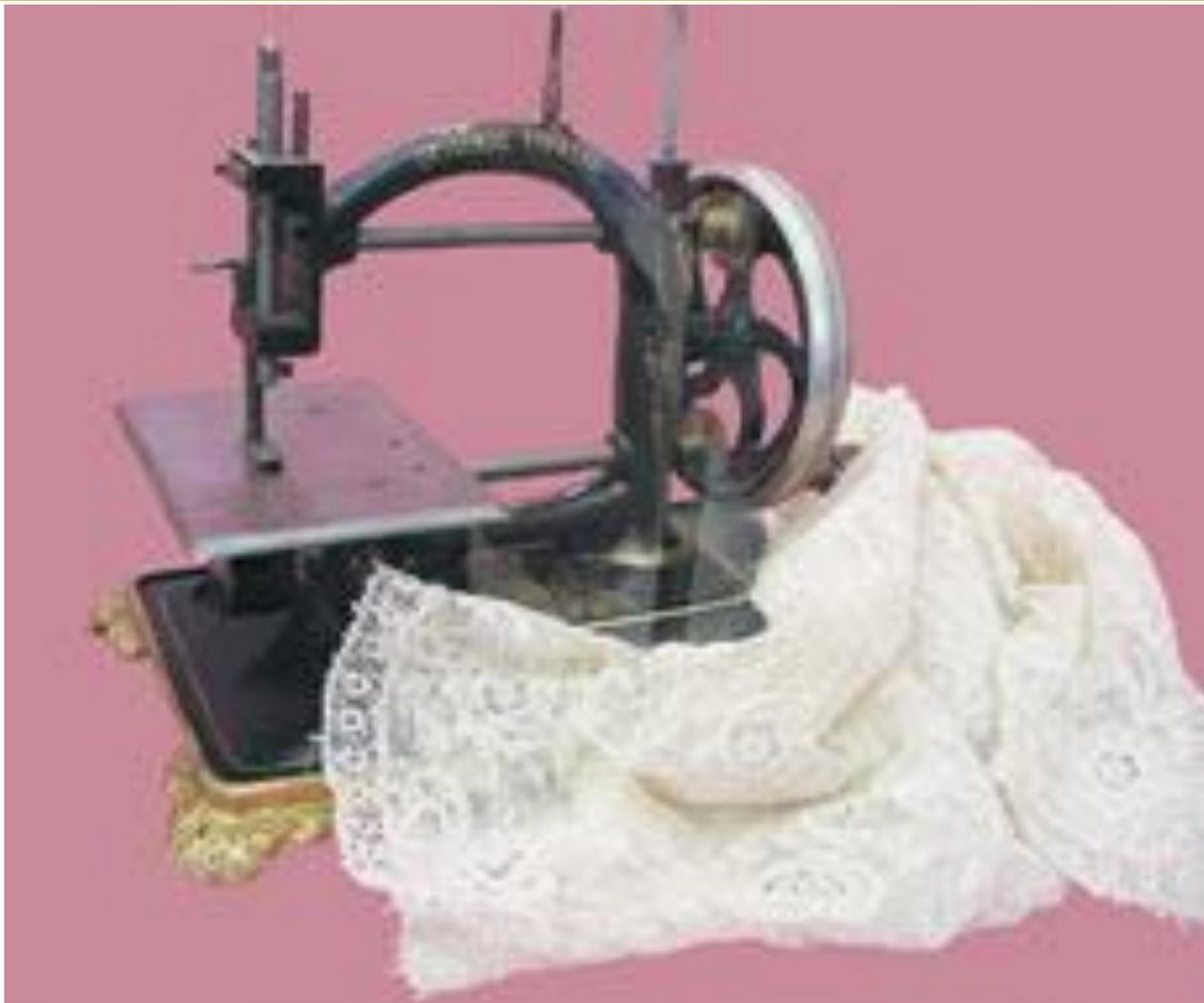
Швейная машина "Оригиналь экспресс" цепного стежка (США, 1860-1880). Основание выполнено в технике художественного литья, что соответствует технической моде второй половины 19 века.
