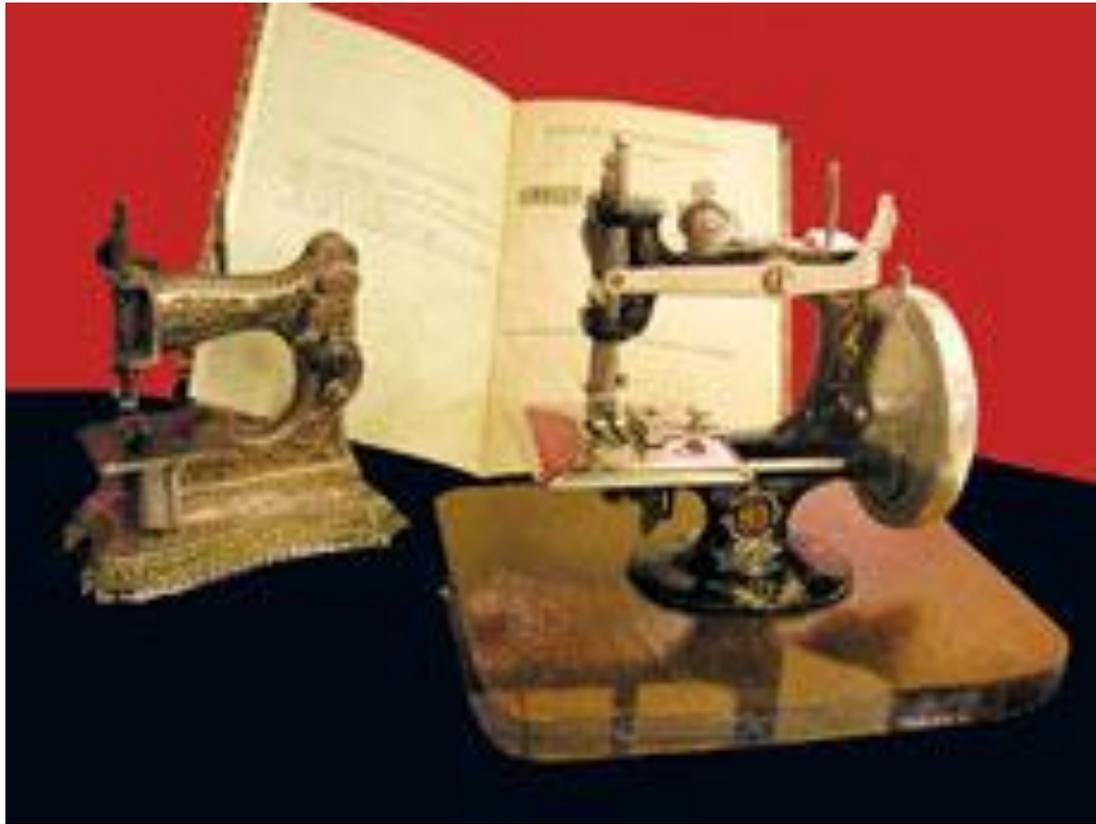
Справа - детская швейная машина цепного стежка с деревянным основанием и литым фигурным корпусом, украшенным многоцветной росписью (Подольский механический завод, 1935-1940). Слева - детская швейная машина цепного стежка с литым художественным корпусом (Западная Европа, 1910-1930)
