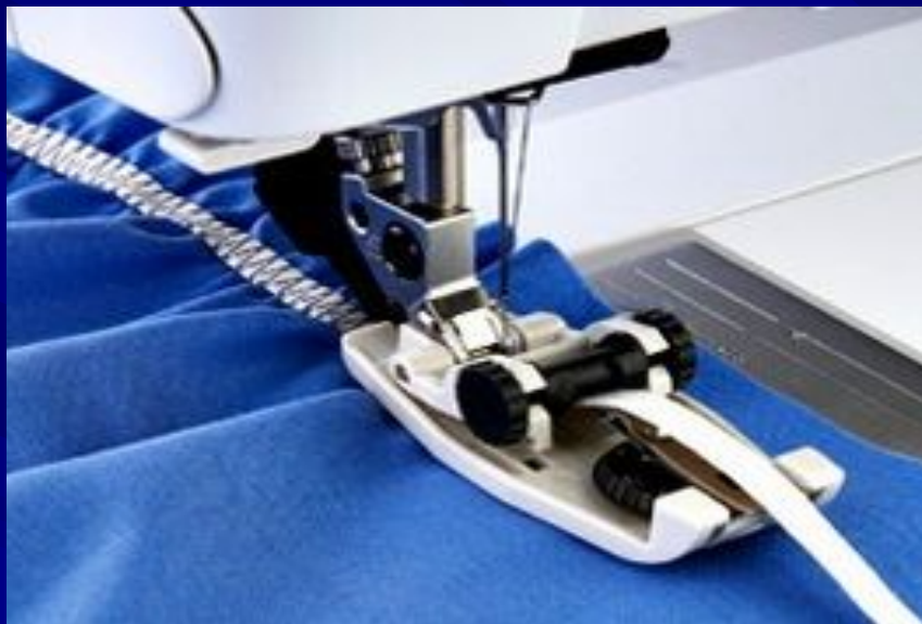
Лапка для вшивания шнура
