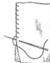
Сшивание полотнищ по кромке
