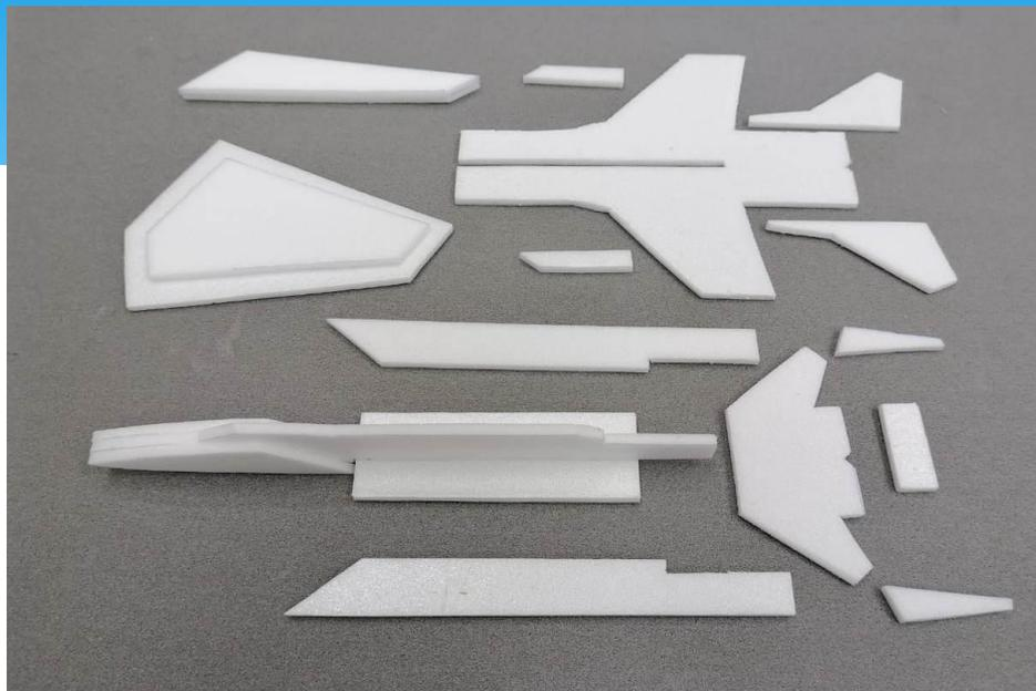
Для тренировки склеивания начнем с подставки: дет. 1 приклеиваем к дет. 2, оставляем сохнуть и склеиваем дет. 3 и 4.
