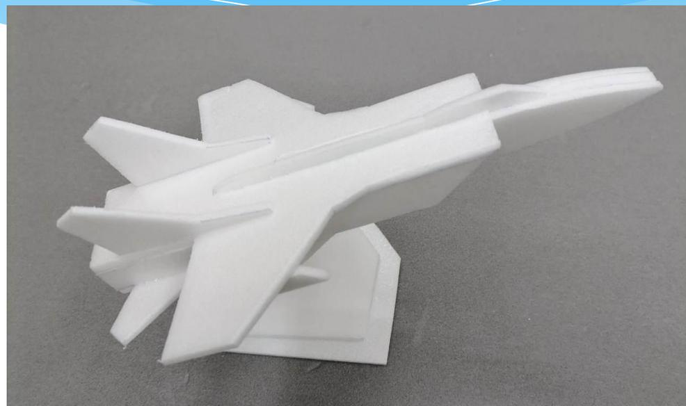
Устанавливаем фальшкиль – дет. 14 и 15 , пилоны ракет и приклеиваем модель на подставку. Можно приступать к раскрашиванию модели. Вариантов много: можно сделать аппликацию –звезды и бортовые номера, можно модель раскрасить фломастерами , гуашевыми или акриловыми красками.
