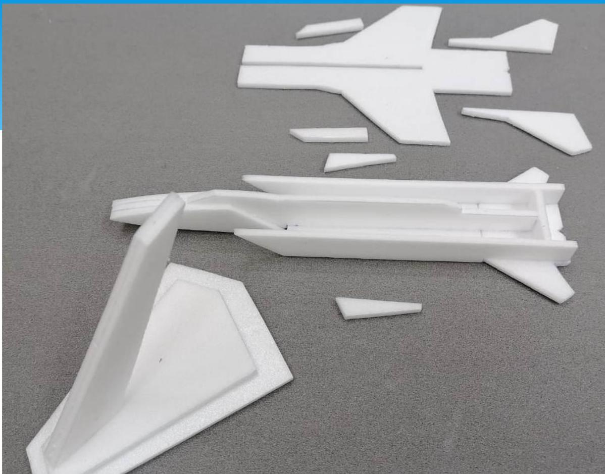
Дет. 9 – стабилизатор приклеиваем встык к дет. 8, и в торец фюзеляжа сзади поперек клеим дет. 10 смотри рисунок. Пока подсыхают детали фюзеляжа склеиваем основание подставки и ножку согласно рисунку. Затем приклеиваем левый и правый борт воздухозаборника дет.11 и 12 (обязательно чтобы деталь 8 находилась между деталями 11 и 12).
