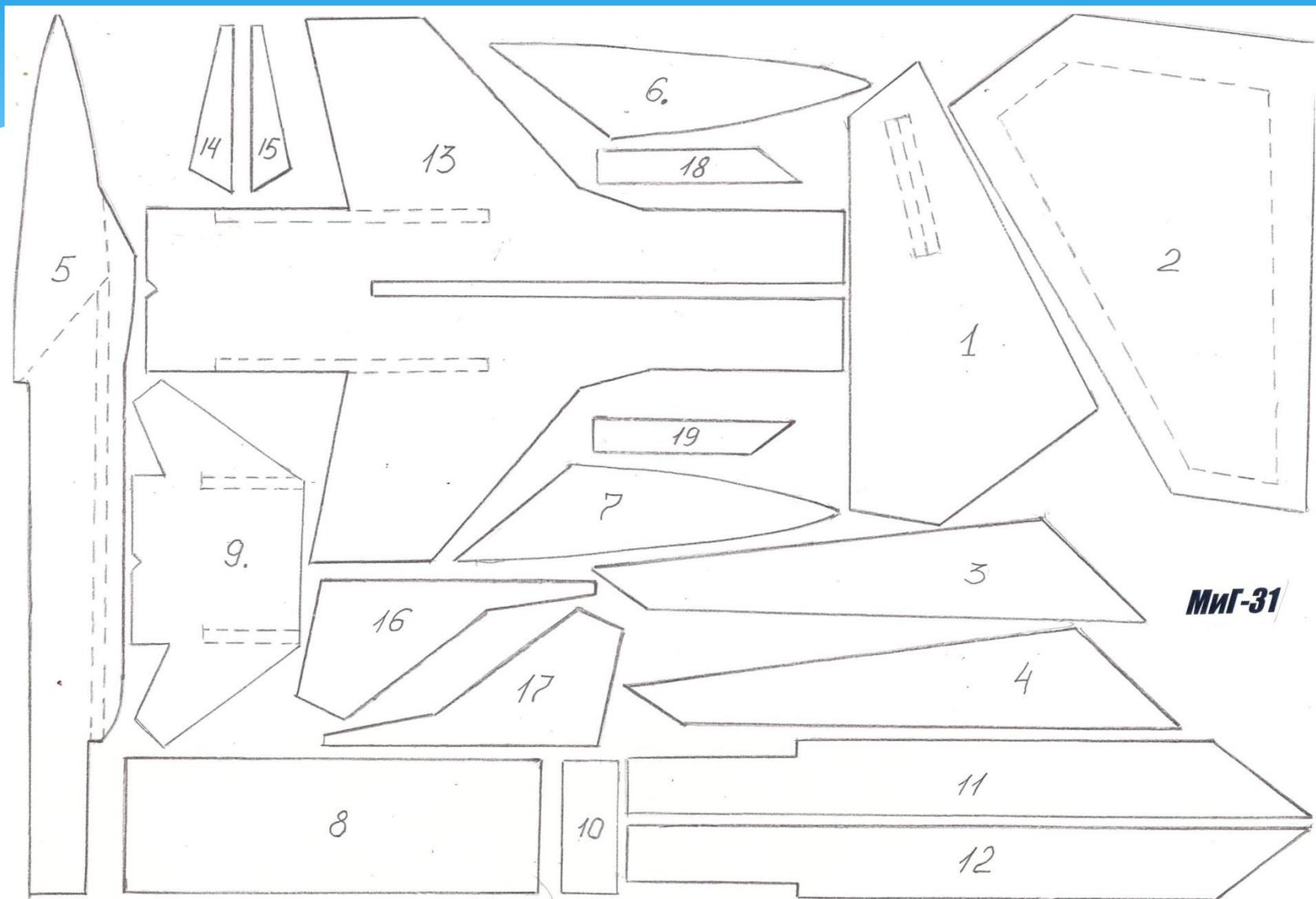
Вырезаем шаблоны и ручкой наносим их контур на пенопласт, после вырезаем детали
