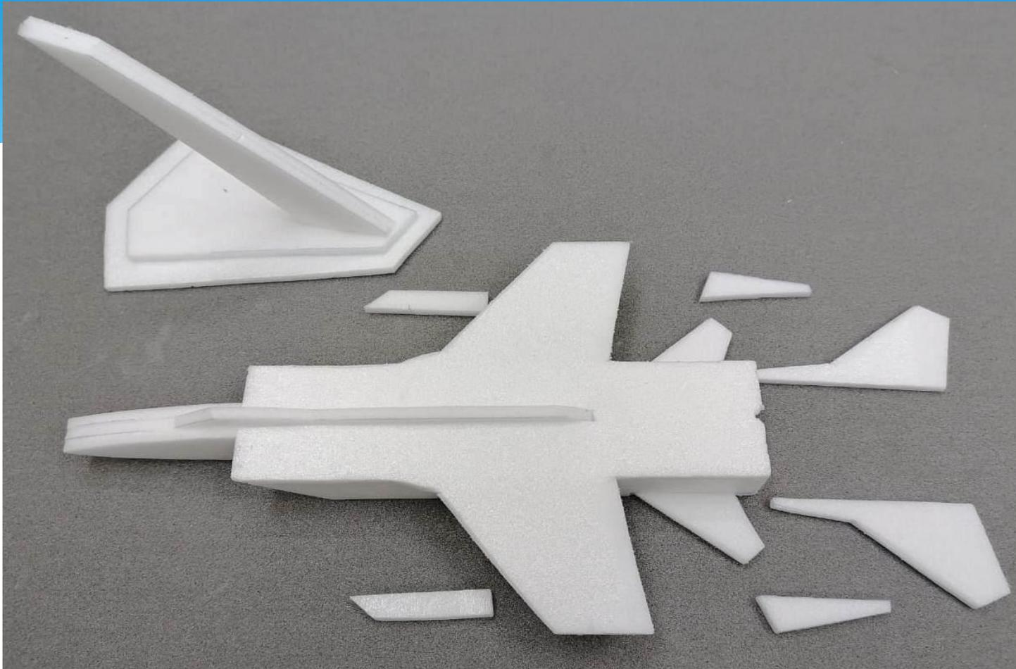
Дет. 13 клеим на детали воздухозаборника и фюзеляж. Затем приклеиваем киль детали 16 и 17 .
