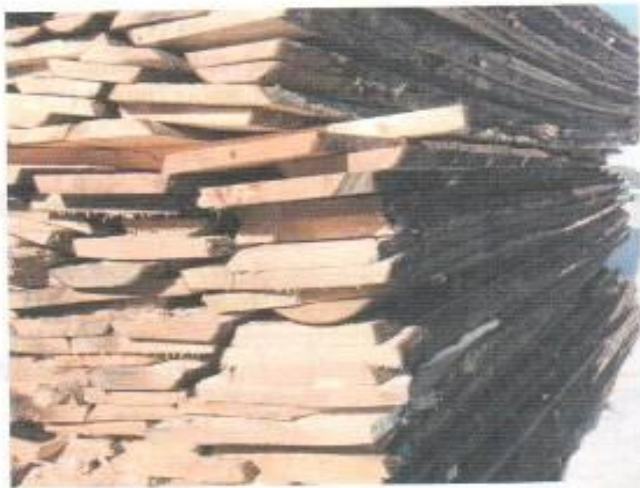
Рис. 9. Пример неправильной сушки древесины
