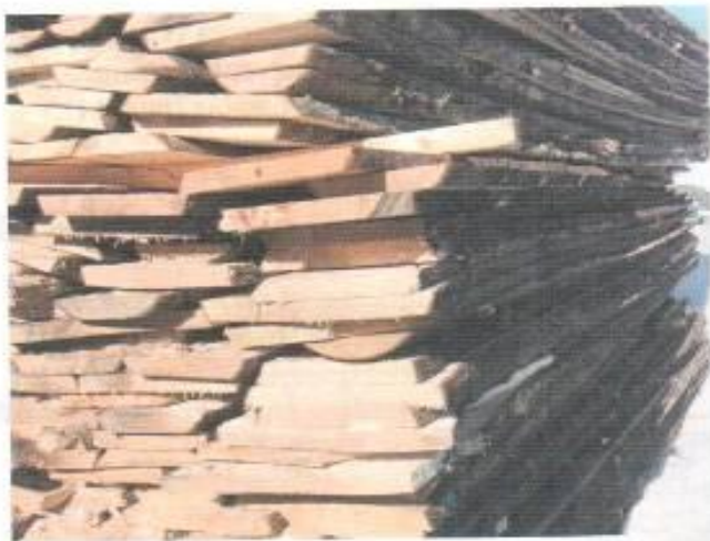
Рис. 9. Пример неправильной сушки древесины
