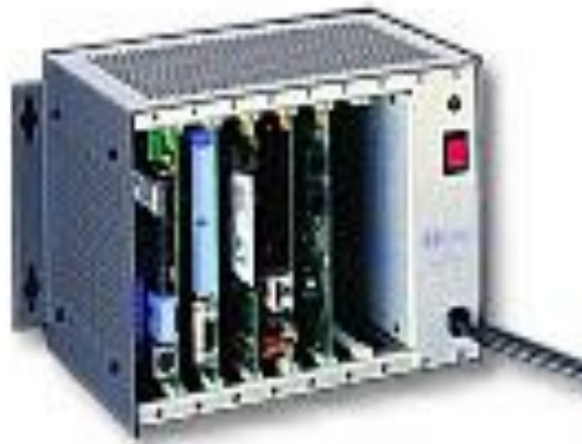
Контроллер MicroPC компании Octagon Systems
