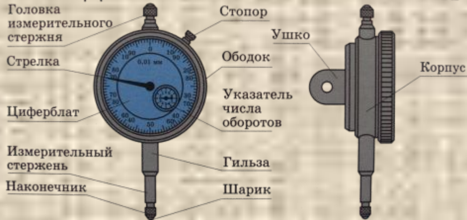
Измерение индикаторной скобой
