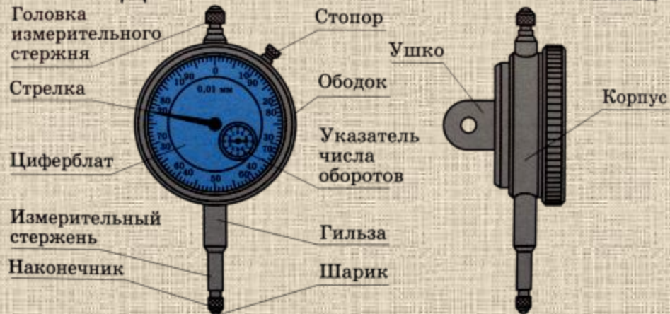
Измерение индикаторной скобой
