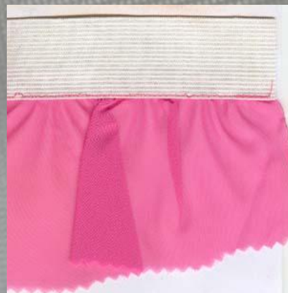
в) Настрочить эластичную тесьму с растяжением на верхний край юбки на стачной машине
