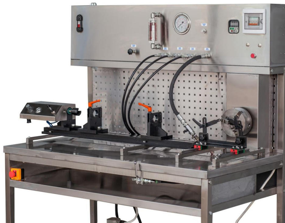
Стенд для рулевых реек MS 503.
