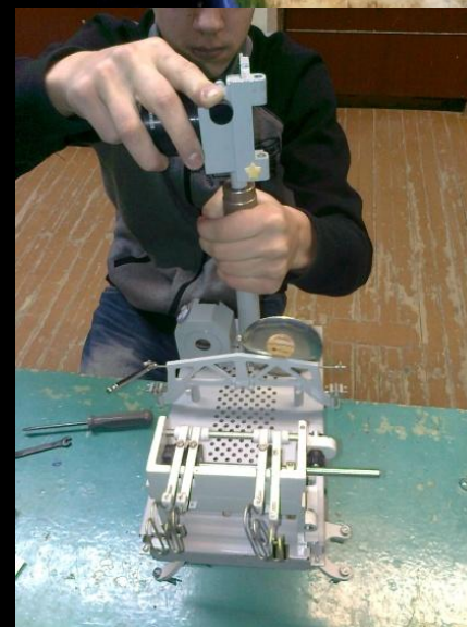
Монтаж панорамной телефотокамеры горизонтального и вертикального обзора.
