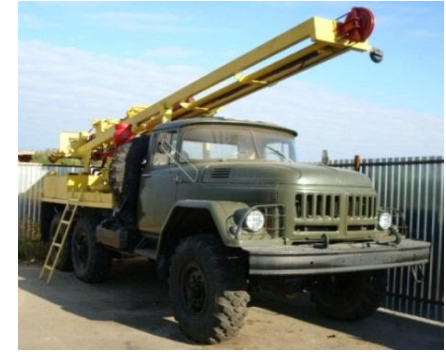
Буровая установка на базе грузового автомобиля Урал 4320-07
