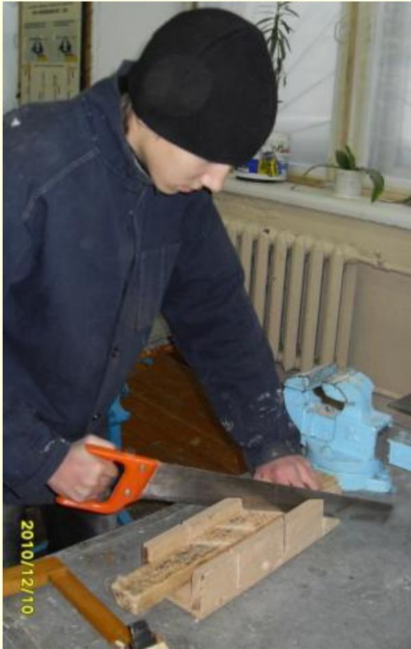
в установленных местах (пиление, обтесывание, долбление, сверление, соединение деталей), используя приспособления, упоры и подкладные доски
