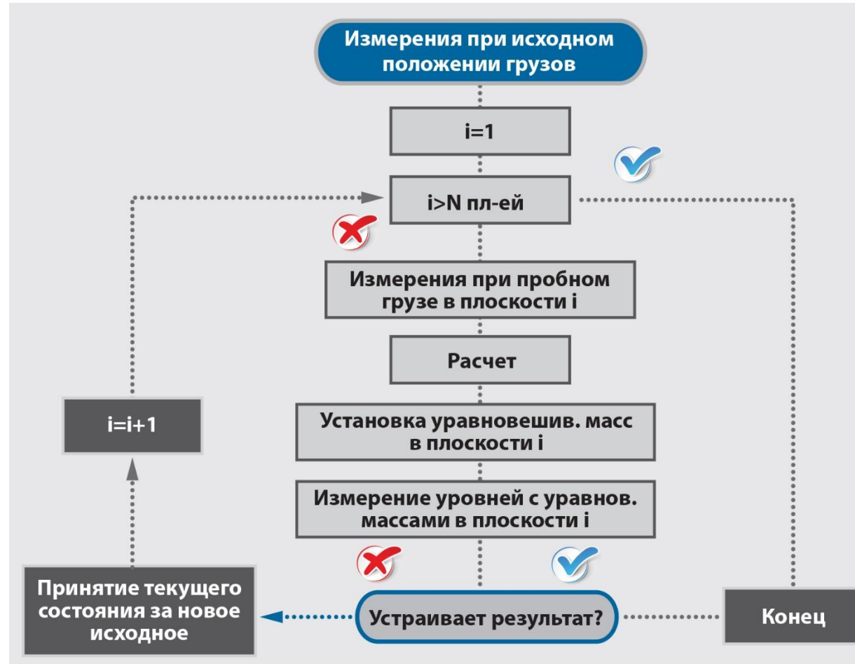
Структурная схема алгоритма проведения измерений и расчетов при одноплоскостной балансировке
