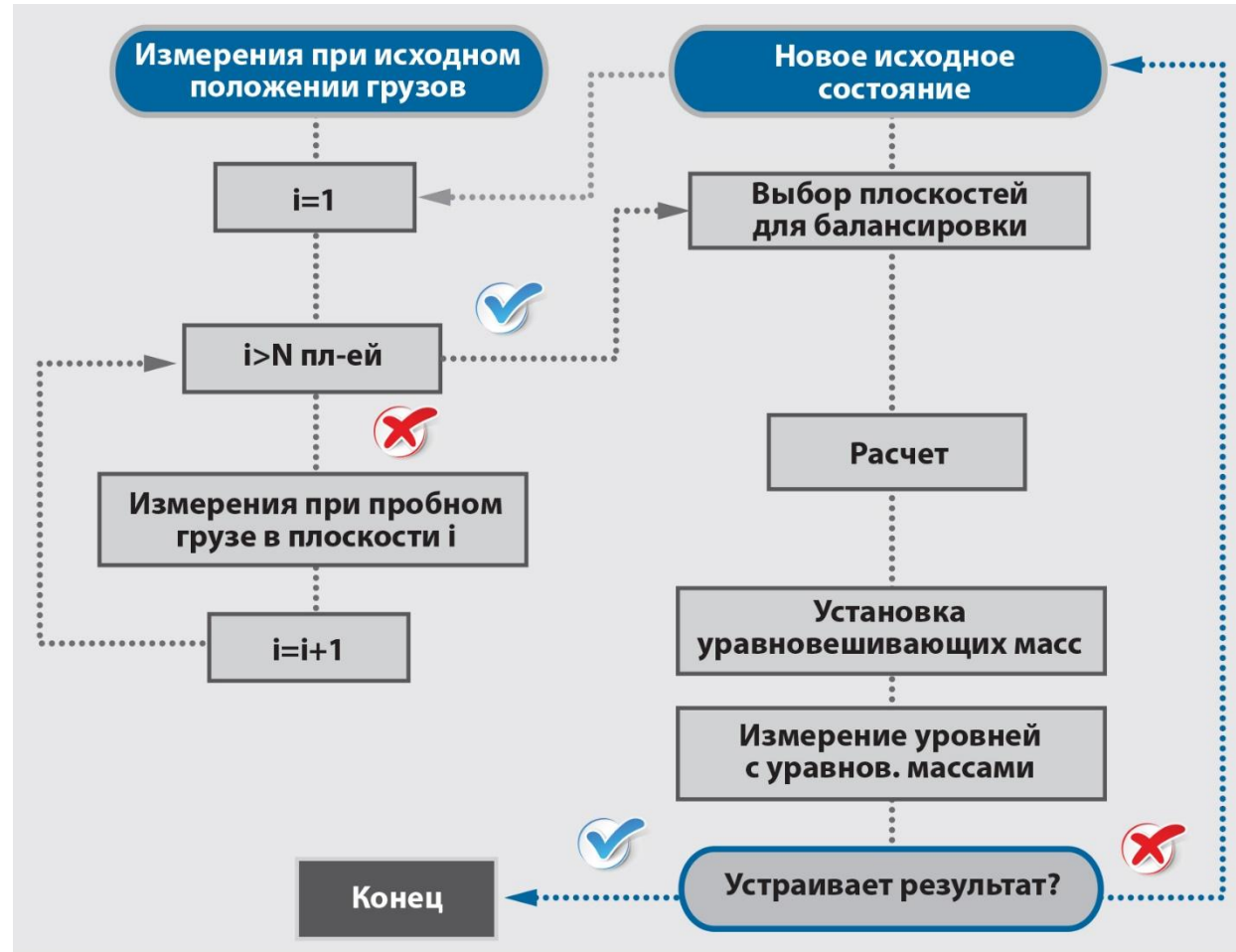
Структурная схема алгоритма проведения многоплоскостной балансировки
