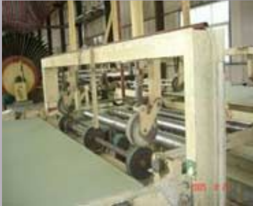
Станок для шлифовки торцов.
