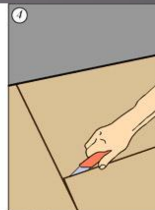
Предпоследний в ряду лист уложить на последний, который подрезать
