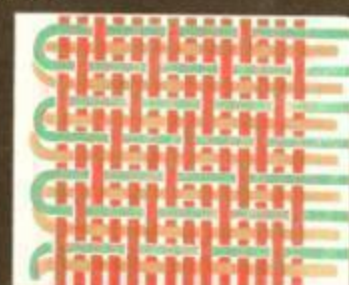
ДВУХЛИЦЕВОЕ ПЕРЕПЛЕ- ТЕНИЕ С ОДНОЙ НИТЬЮ ОСНОВЫ И ДВУМЯ НИТЯМИ УТКА
