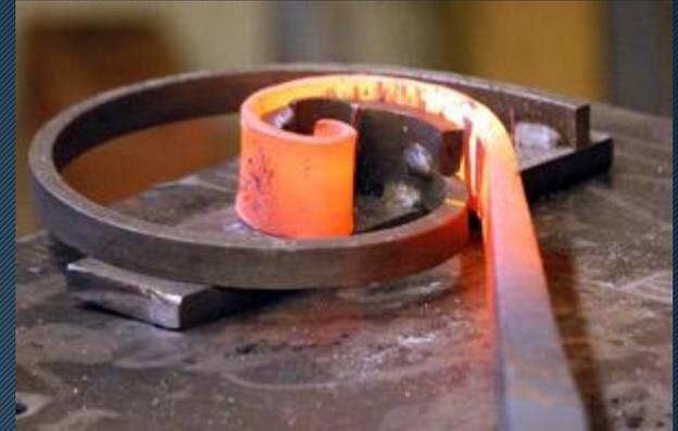
Пластичность - способность изменять форму под действие внешних сил не разрушаясь
