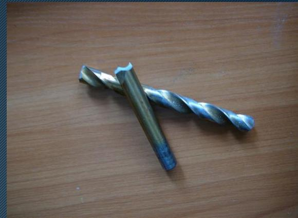
Хрупкость - Способность металлов и сплавов разрушаться под действием ударных нагрузок. Хрупкость – свойство, обратное вязкости.
