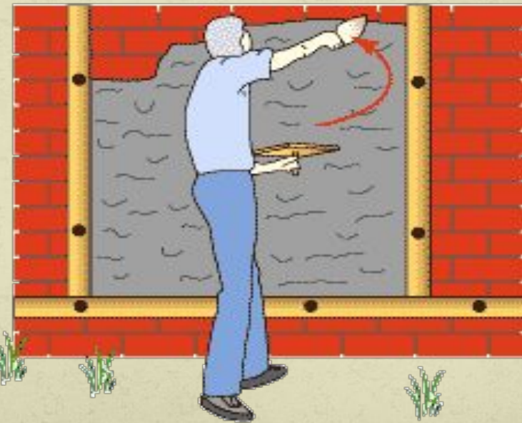
набрасывание слоя бетона
