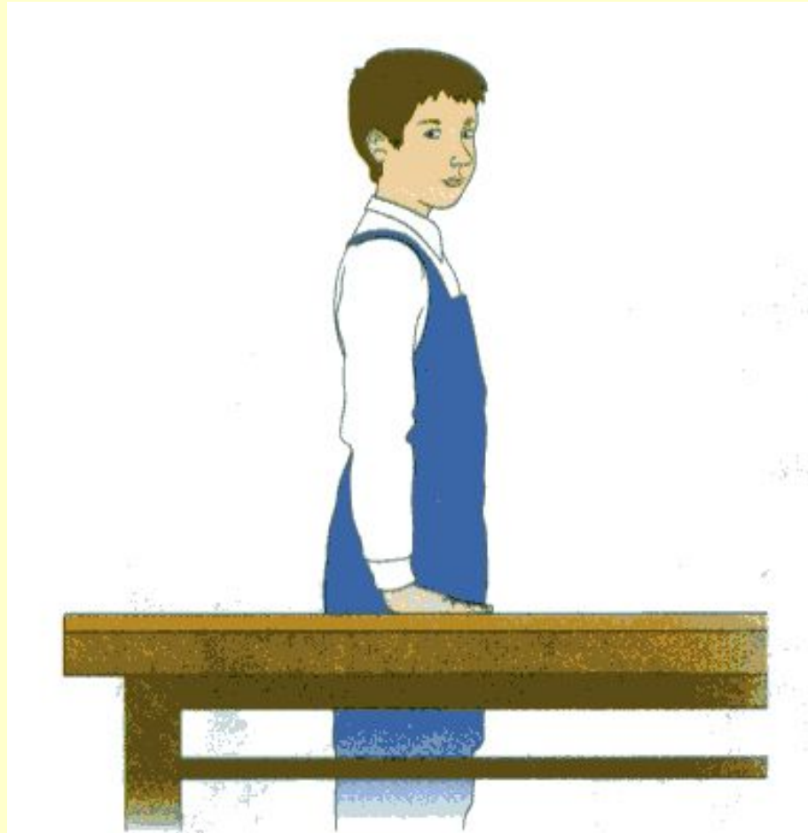
Рис. 16. Соответствие верстака росту работающего
