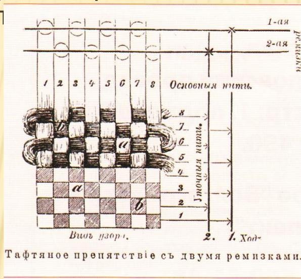
Этим переплетением вырабатываются большинство х/б тканей (ситец, бязь, батист, крепдешин и т.д.), а так же большинство льняных полотен, шелковых и смесовых тканей.
