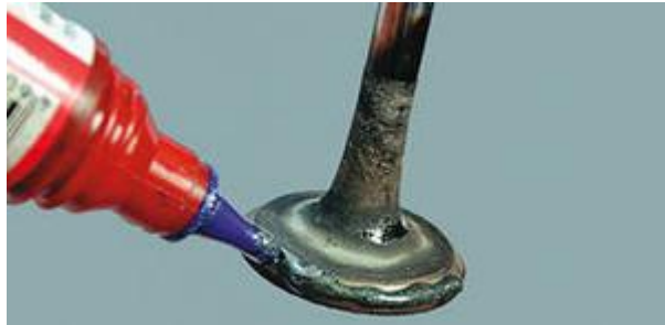
Нанесение притирочной пасты
