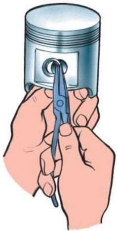
Снятие стопорного кольца поршневого пальца
