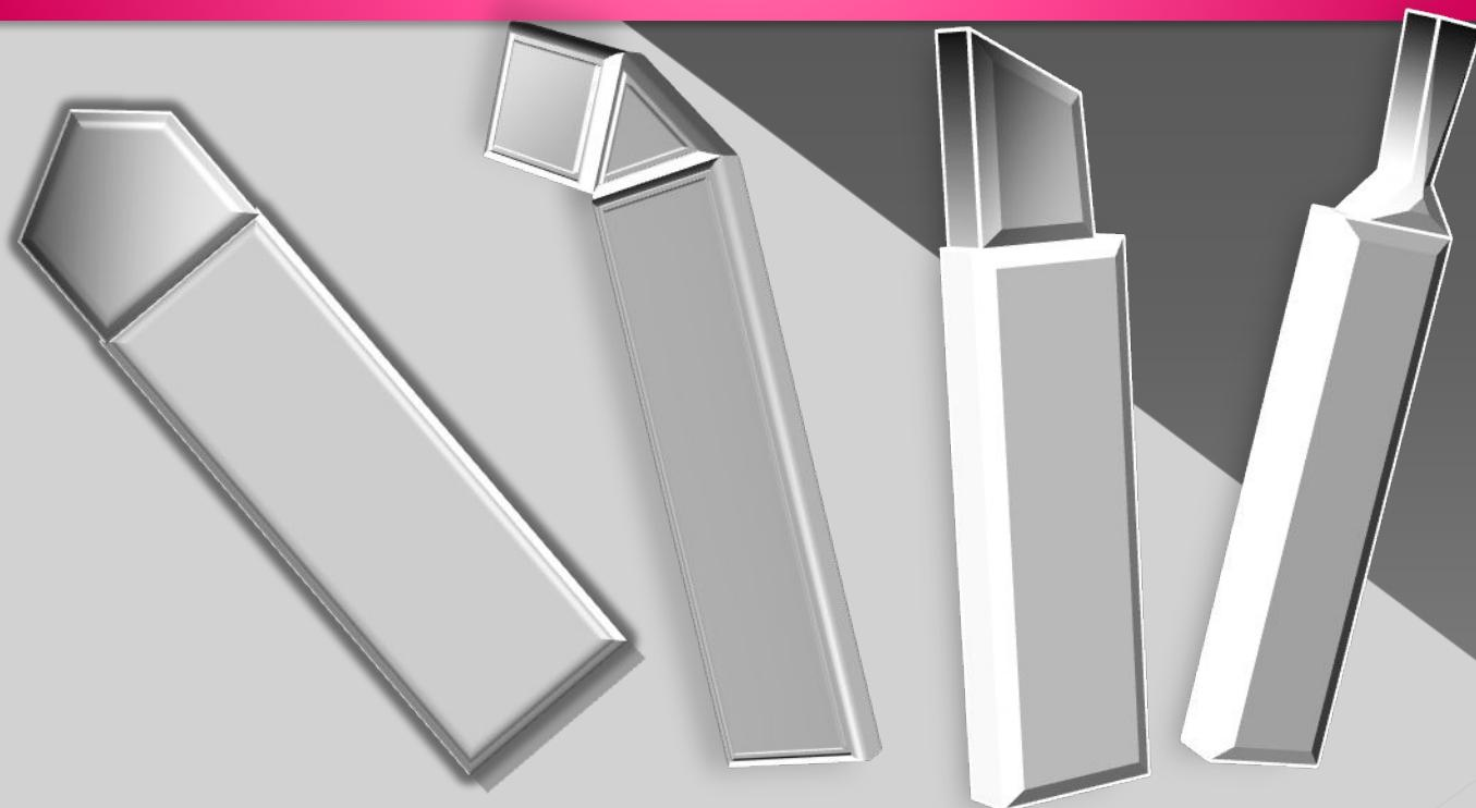
**Резец – это режущий инструмент, предназначенный для обработки деталей различных размеров, форм и материалов. Является основным инструментом, применяемых при токарных работах.**
