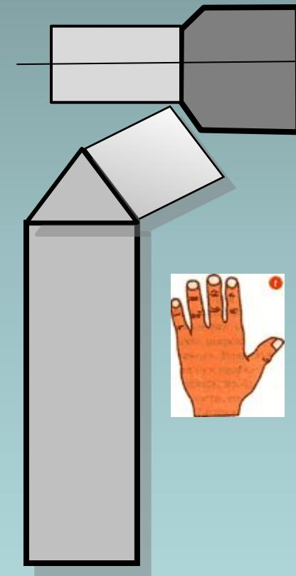
**Проходной резец предназначен для точения
