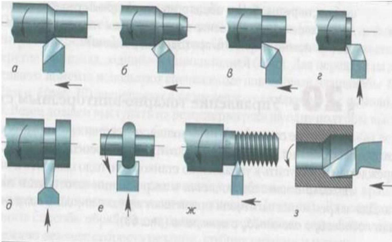
Токарные резцы: а— проходной прямой; б— проходной отогнутый;
