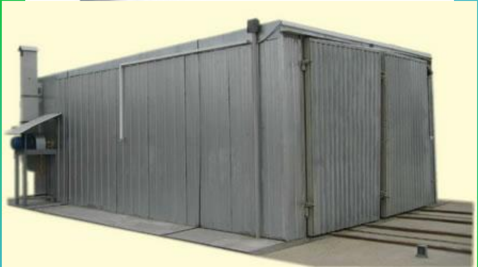
пресс-вакуумная сушильная сборно-металлическая камера камера
