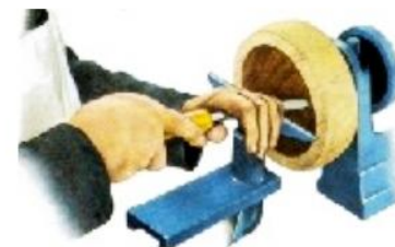
поперечное точение (торцовое, лобовое)
