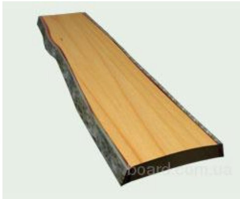
**Пластины** - плоские полосы какого-либо твердого или упругого материала с гладкой поверхностью (бревно распилено пополам)
