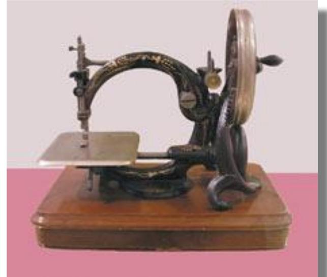
*Швейная машина цепного стежка фирмы "Вилькоккс и Гиббс" (США, Нью-Йорк, 1868).
