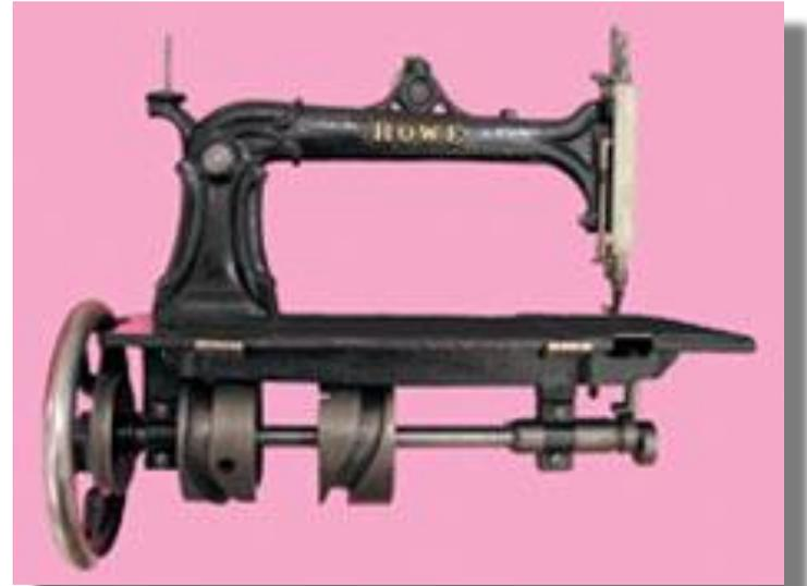
*Фабрично-ремесленная швейная машина "Гоу" челночного стежка для стачивания тяжелых тканей. Изготовлена на фирме "Гоу-машина-компани" (США, Нью-Йорк, 1865-1875), принадлежащей семье изобретателя швейной машины челночного типа Элиаса Гоу. Применялась в основном для шитья парусов для флота.*
