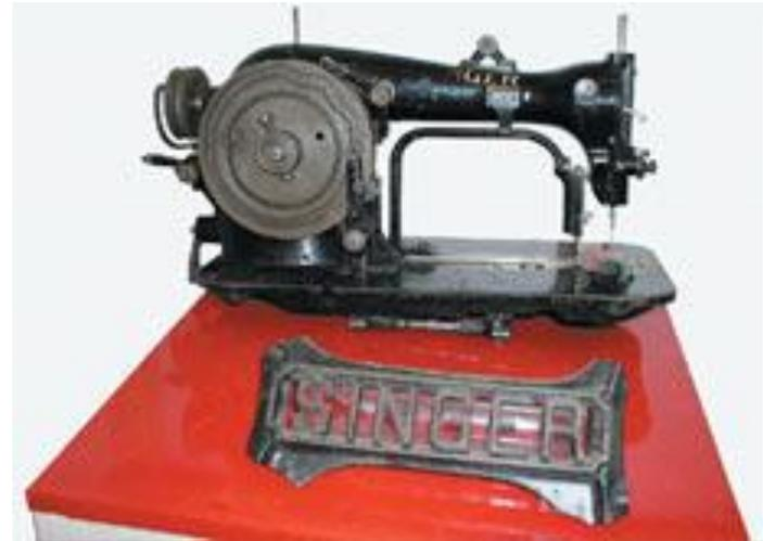
*Швейная машина фирмы "Зингер" (США, 1900-1915), предназначенная для изготовления закрепок и укрепления петель, пришивания бантиков к обуви и платью.*
