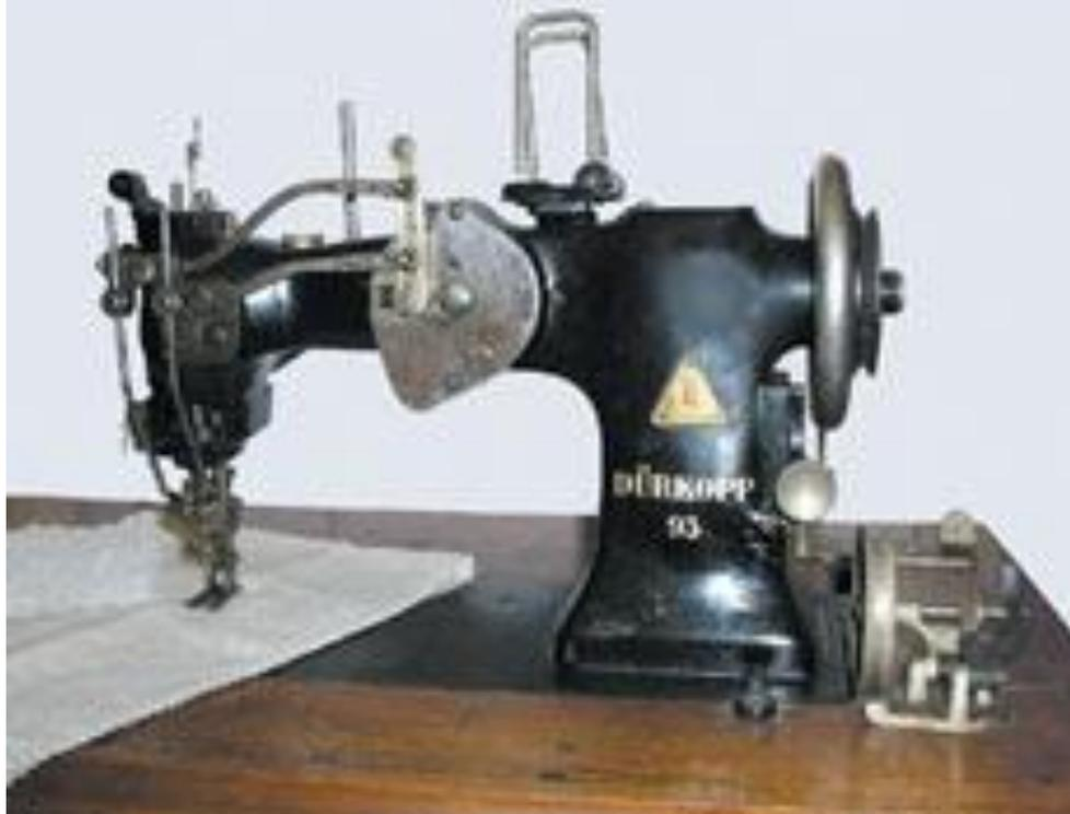
*Фабрично-ремесленная швейная машина челночного стежка фирмы "Дюркопп" (Германия, 1900-1915). Предназначена для выполнения ажурных работ, всевозможных мережек для украшения одежды, столового и постельного белья.*
