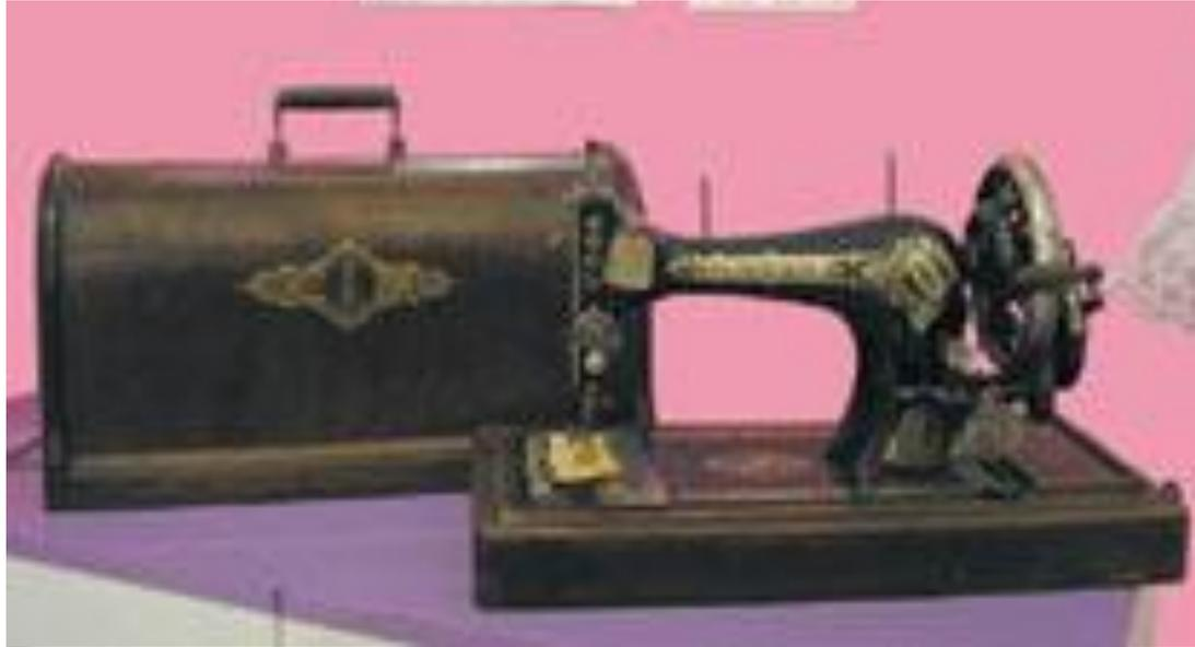
*Швейная машина челночного стежка для стачивания тканей (подольский завод компании "Зингер", 1905-1920). Ее корпус имеет так называемую бутылочную форму, которая была запатентована фирмой "Зингер" в конце XIX века. Благодаря сбалансированности всех конструктивных узлов такие машины обладают большим запасом прочности и до сих пор используются во многих домах России.*
