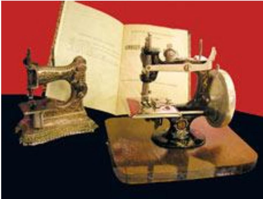
*Справа - детская швейная машина цепного стежка с деревянным основанием и литым фигурным корпусом, украшенным многоцветной росписью (Подольский механический завод, 1935-1940). Слева - детская швейная машина цепного стежка с литым художественным корпусом (Западная Европа, 1910-1930); маховое колесо заменено специальной ручкой.*
