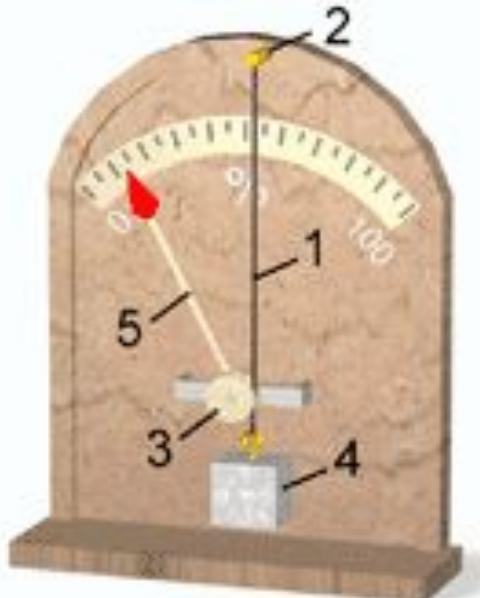
**Волосянной гигрометр**, в котором деталь, чувствительной к изменению влажности, служит обезжиренный человеческий волос [1]. Он закреплен в верхней части прибора [2], обернут вокруг ролика [3] и натянут при помощи специально подобранныго груза [4]. К ролику прикреплена стрелка [5]. При увеличении относительной влажности воздуха волос удлиняется и вызывает вращение ролика вместе со стрелкой. Стрелка, передвигаясь по шкале, указывает значение влажности воздуха, выраженное в процентах.
