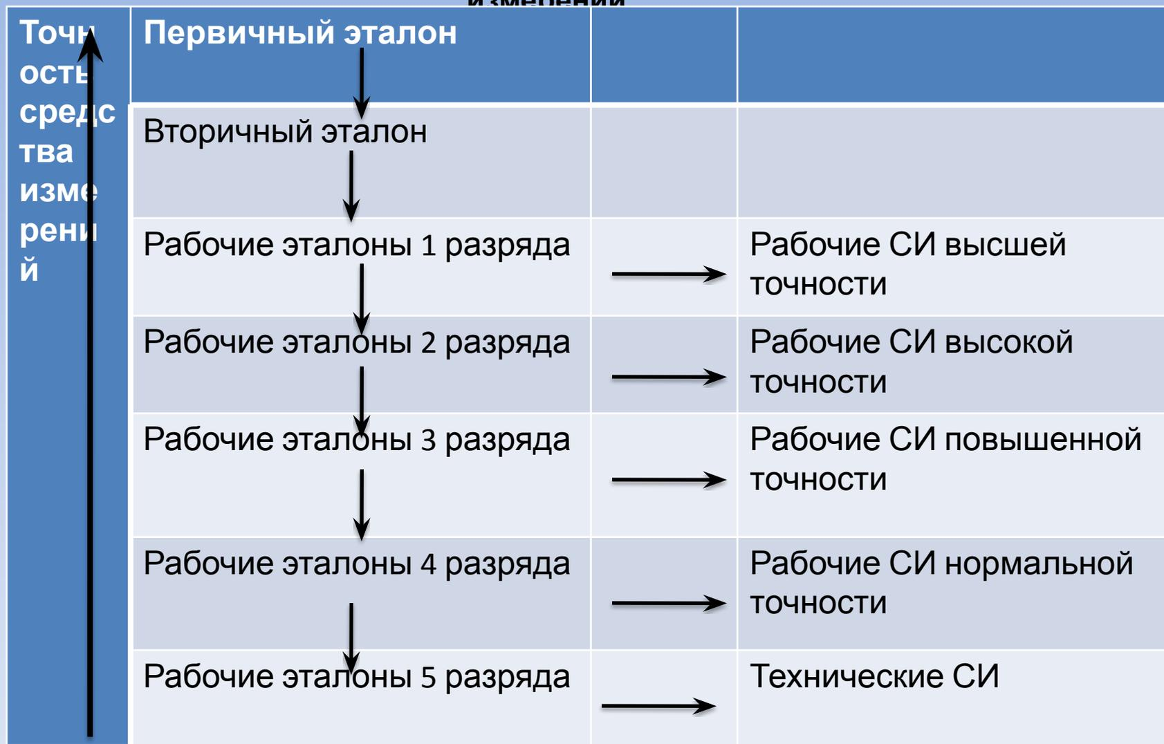
Согласно схеме на рис. 1.1, между разрядами рабочих эталонов существует соподчинённость: рабочие эталоны 1 разряда поверяются, как правило, непосредственно по вторичным эталонам, рабочие эталоны 2-го и последующего разрядов подлежат поверке по рабочим эталонам непосредственно предшествующих разрядов.
