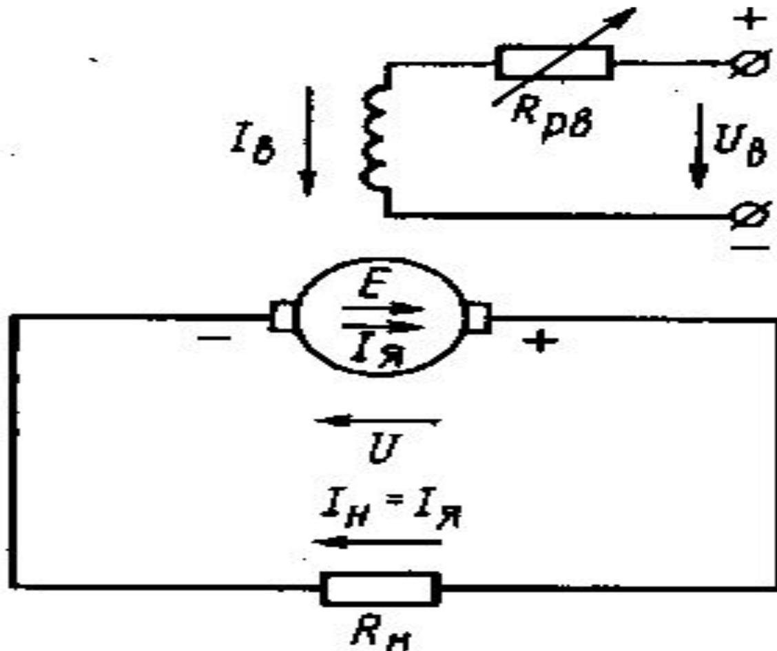
Рис 120 Принципиальная схема генератора с независимым возбуждением
