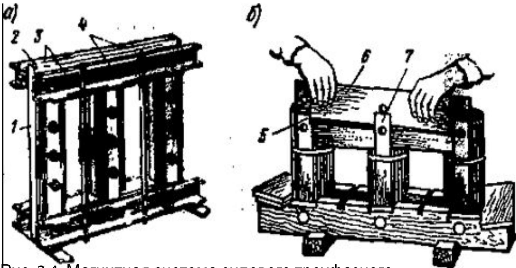
Рис. 2.4. Магнитная система силового трехфазного трансформатора:
