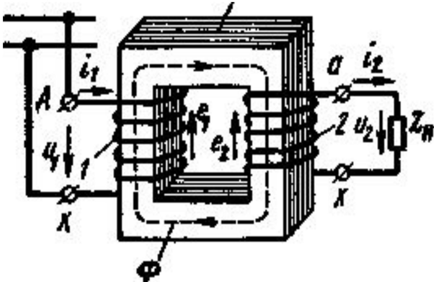
Рис. 2.1. Электромагнитная система однофазного трансформатора :
