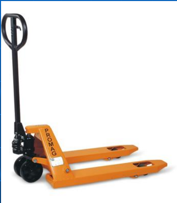
Ручная тележка PR 2000/800 грузоподъемность 2000 кг короткие вилы - 800 мм колеса на дышле - нейлон
