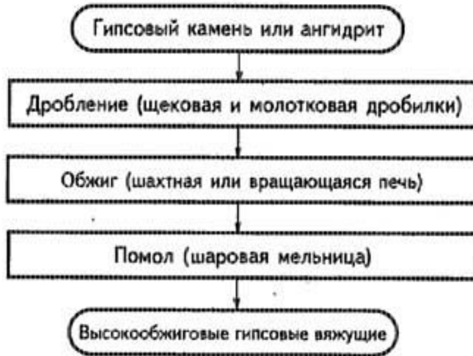
Рис. 3.5. Технологическая схема производства высокообжиговых гипсовых вяжущих
