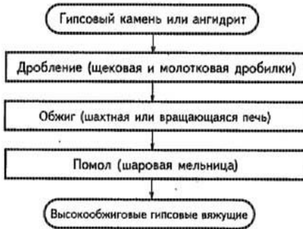
Рис. 3.5. Технологическая схема производства высокообжиговых гипсовых вяжущих
