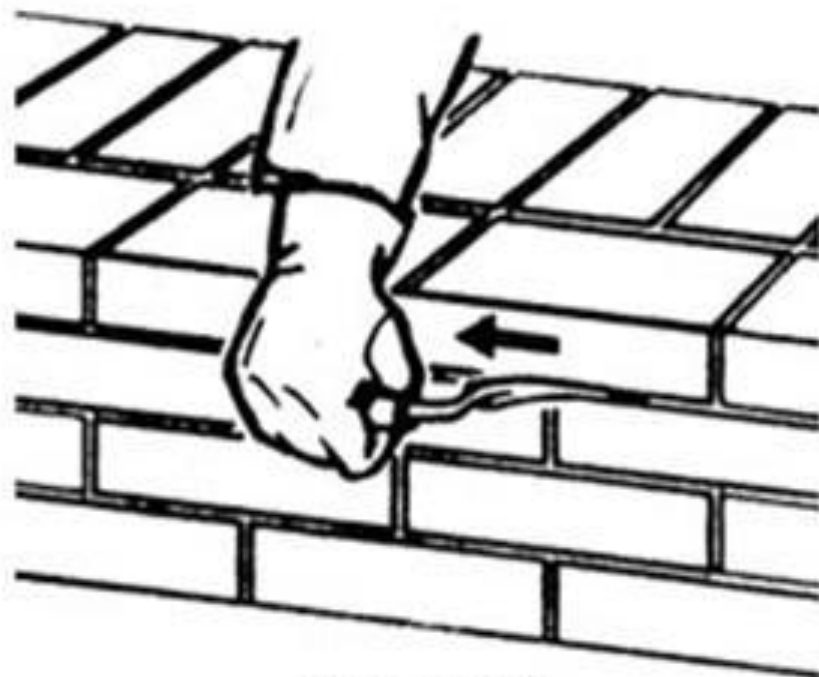
Расшивка горизонтальных швов
