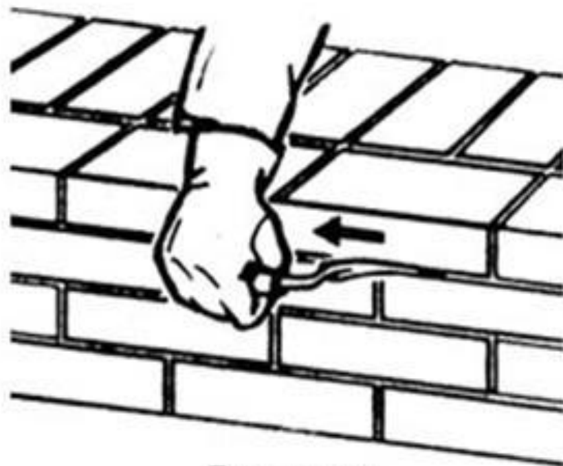
Расшивка горизонтальных швов
