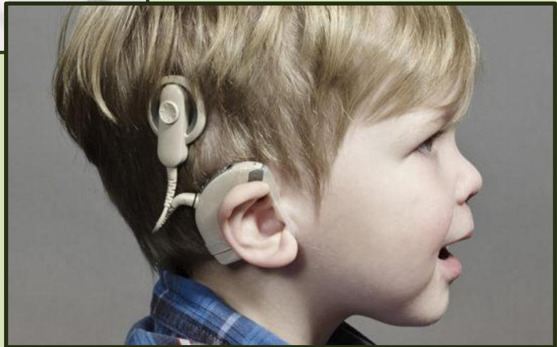
□ Каждый речевой процессор программируется индивидуально в соответствии с состоянием слуха. Мозг получает информацию в течение нескольких микросекунд после приема звука микрофоном, так что можно слышать звуки практически в момент их появления.
