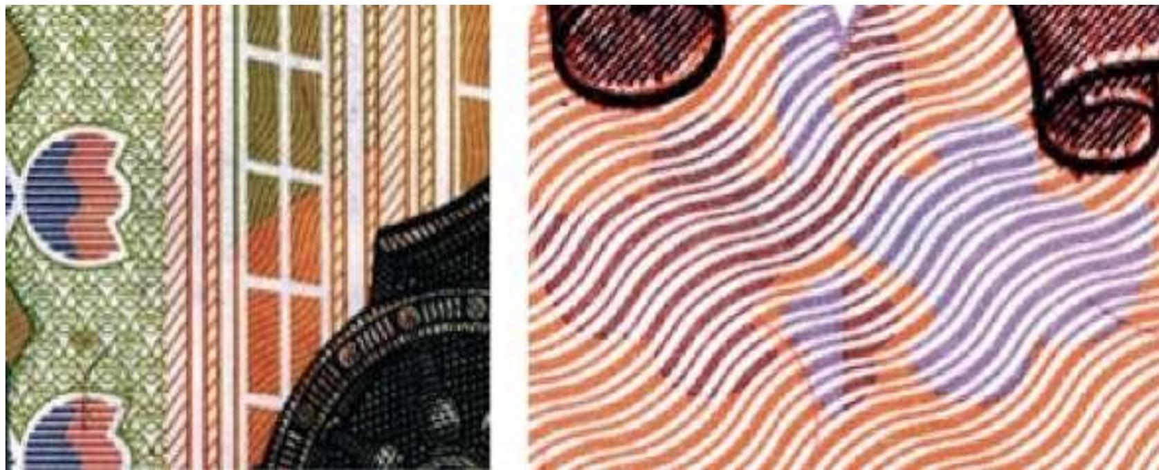
В орловской печати используется сложнейшая технология и высокоточное оборудование. В печатный узел введены мягкий эластичный вал и промежуточные формы - шаблоны (шаблонные валы), имеющие рисунок для каждого цвета оригинала.
