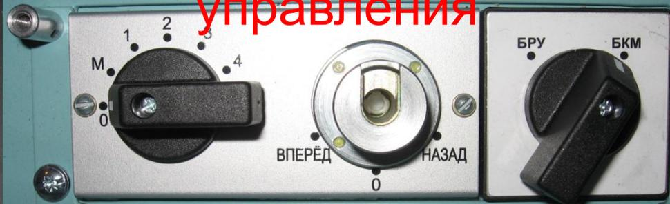
Проверить, что переключатель позиций в положении «0», реверсивный вал БРУ в «0», переключатель БРУ-БКМ в положении БКМ
