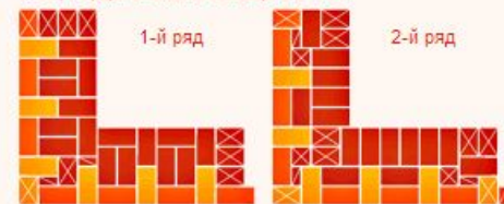
Угол, торцы стены с четвертью и без
