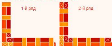
Угол, торцы стены с четвертью и без
