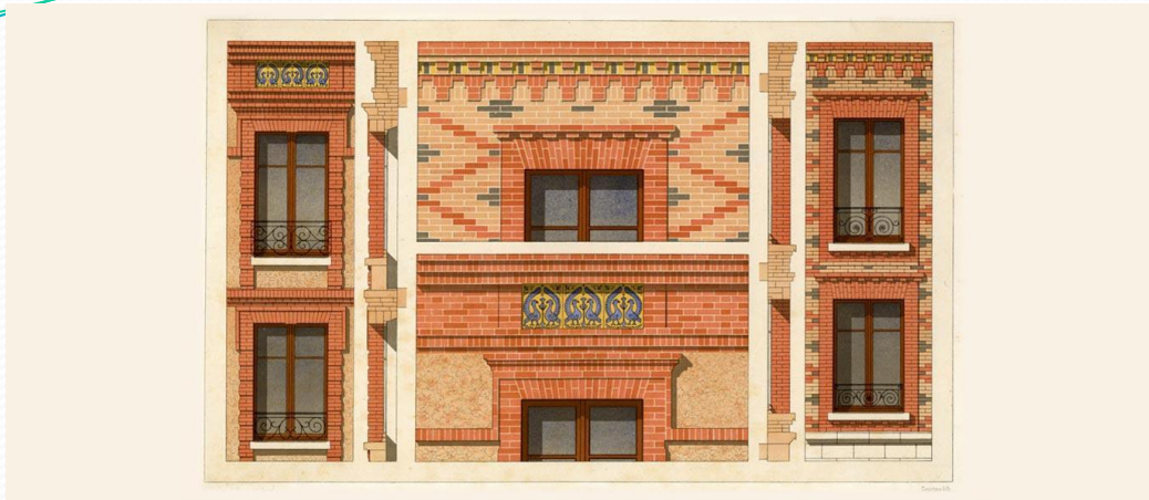
Кладка стены с декоративным рисунком швов
