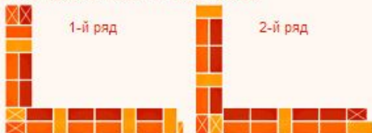
Угол, торцы стены с четвертью и без
