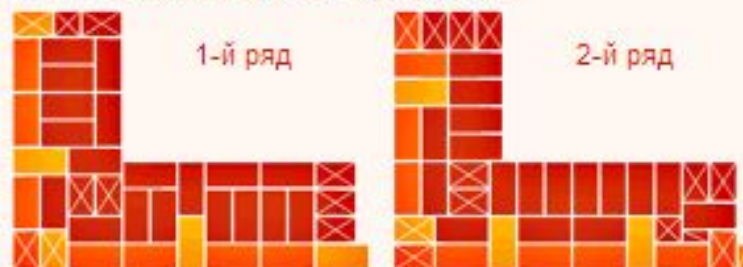
Угол, торцы стены с четвертью и без
