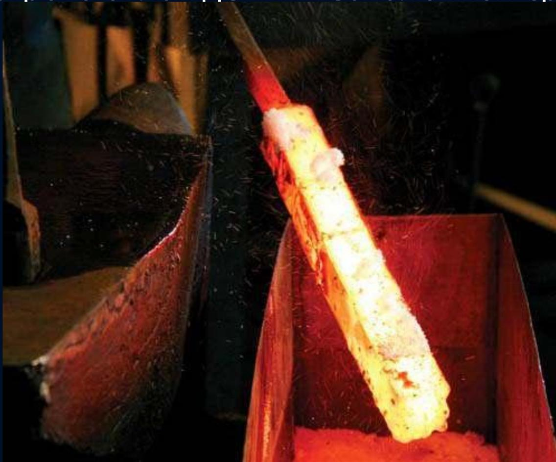
Для исправления такого дефекта деталь подвергают высокому отпуску и повторной закалке
