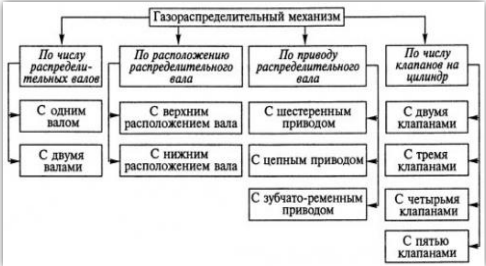
Рисунок 1 – Типы газораспределительных механизмов, классифицированных по различным признакам
