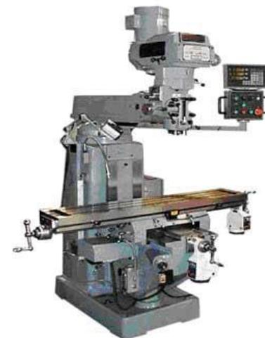
**Универсально-фрезерные** станки предназначены для выполнения разнообразных фрезерных работ цилиндрическими, торцевыми, концевыми, фасонными и другими фрезами. Применяются для обработки горизонтальных и вертикальных плоскостей, пазов, рамок, углов, зубчатых колес, спиралей, моделей штампов, пресс-форм и других деталей из стали, чугуна, цветных металлов, их сплавов и других материалов.
