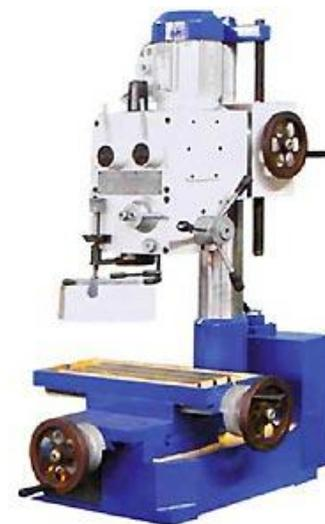
**Сверлильно-фрезерные** станки предназначены для выполнения сверлильных и фрезерных, резьбонарезных работ различных деталей из черных и цветных металлов и их сплавов в условиях серийного и мелкосерийного производства.
