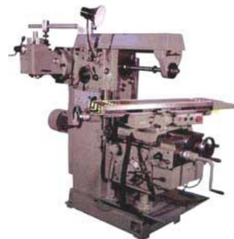
**Консольные горизонтально-фрезерные** станки предназначены для выполнения разнообразных фрезерных работ цилиндрическими, торцевыми, концевыми, фасонными и другими фрезами. Применяются для обработки горизонтальных плоскостей, пазов, рамок, углов, зубчатых колес, спиралей, моделей штампов, пресс-форм и других деталей из стали, чугуна, цветных металлов, их сплавов и других материалов.
