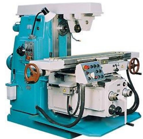
**Фрезерные станки** — предназначены для обработки с помощью фрезы плоских и фасонных поверхностей, тел вращения, зубчатых колёс и т. п. металлических и других заготовок. При этом фреза, закрепленная в шпинделе фрезерного станка совершает вращательное (*главное*) движение, а заготовка, закреплённая на столе, совершает *движение подачи* прямолинейное или криволинейное. Управление может быть ручным, автоматизированным или осуществляться с помощью системы ЧПУ.
