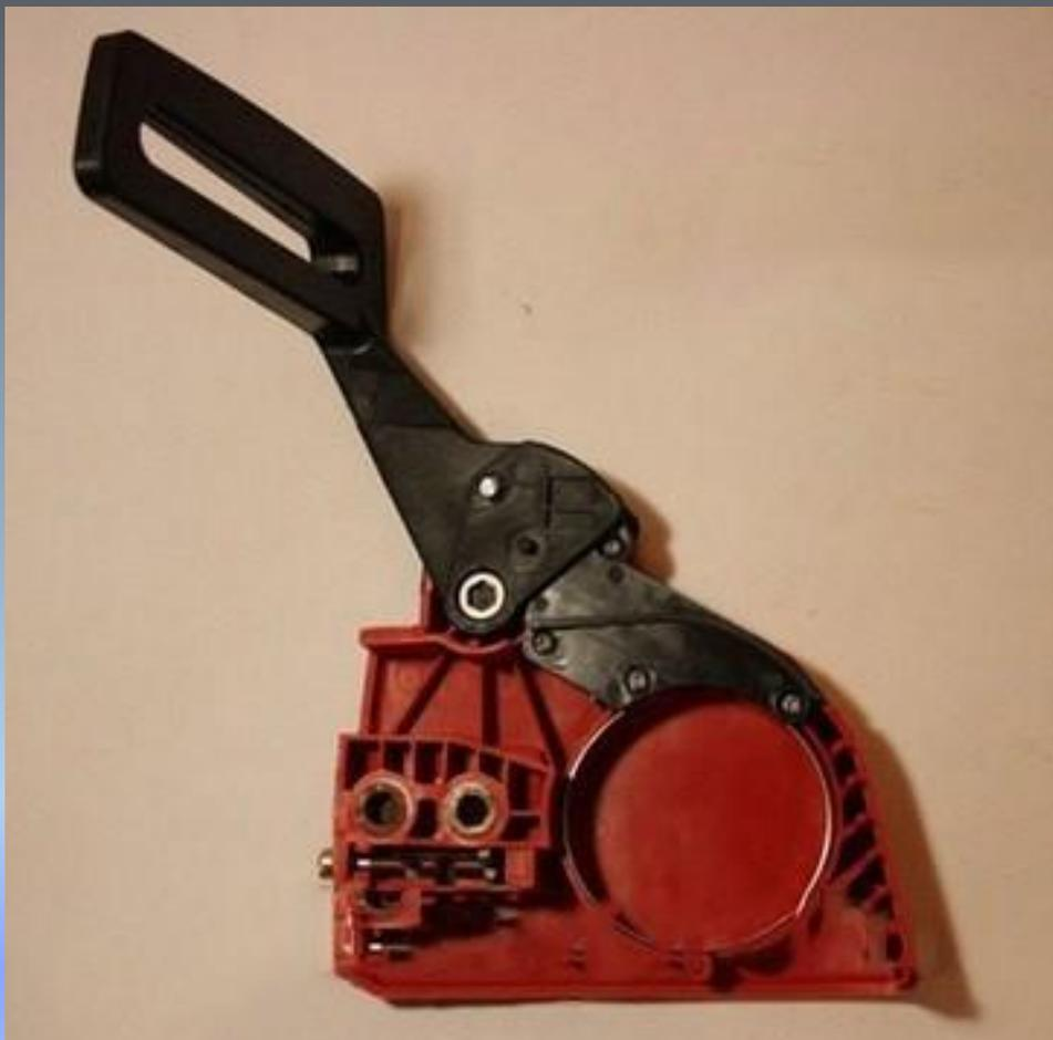
Служит для остановки движения цепи без остановки двигателя. При повороте рычага тормоза цепи лента тормоза останавливает вращение чашки сцепления.
