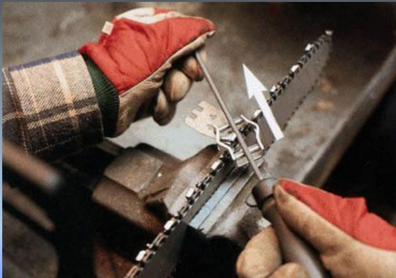
Напильник с приспособлением для заточки с роликами
