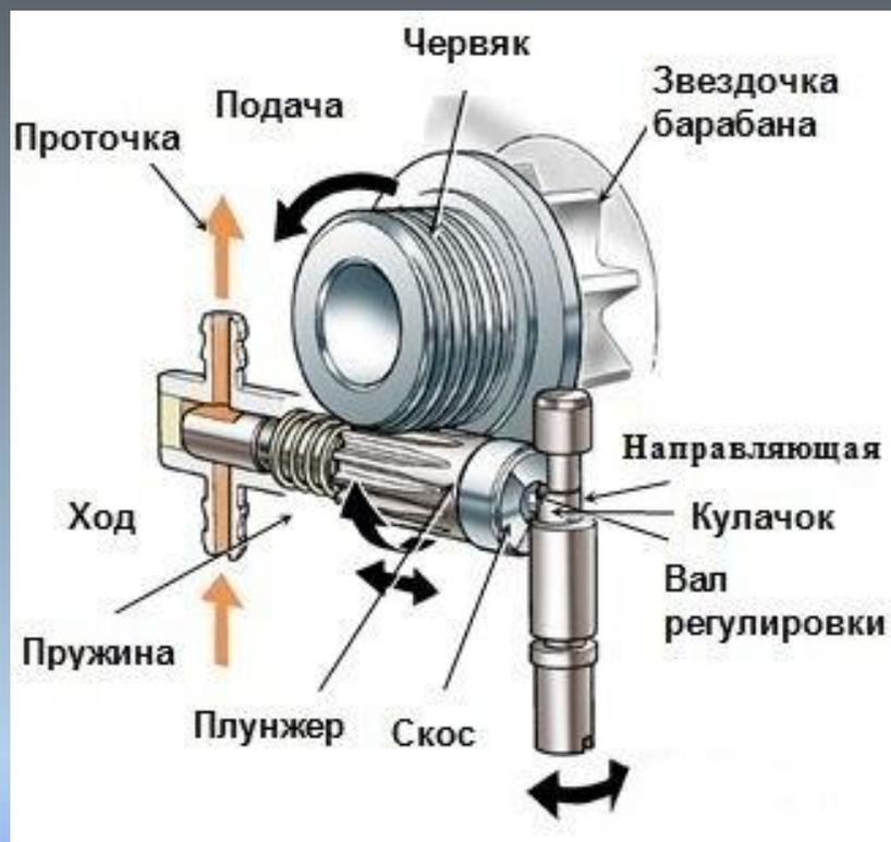
После включения сцепления, приводной червяк начинает вращение плунжер. Плунжер вращаясь, одновременно перемещает такое количество масла, какое определено установкой вала регулирования подачи масла, соединенного с профильной частью торцевой поверхности.
