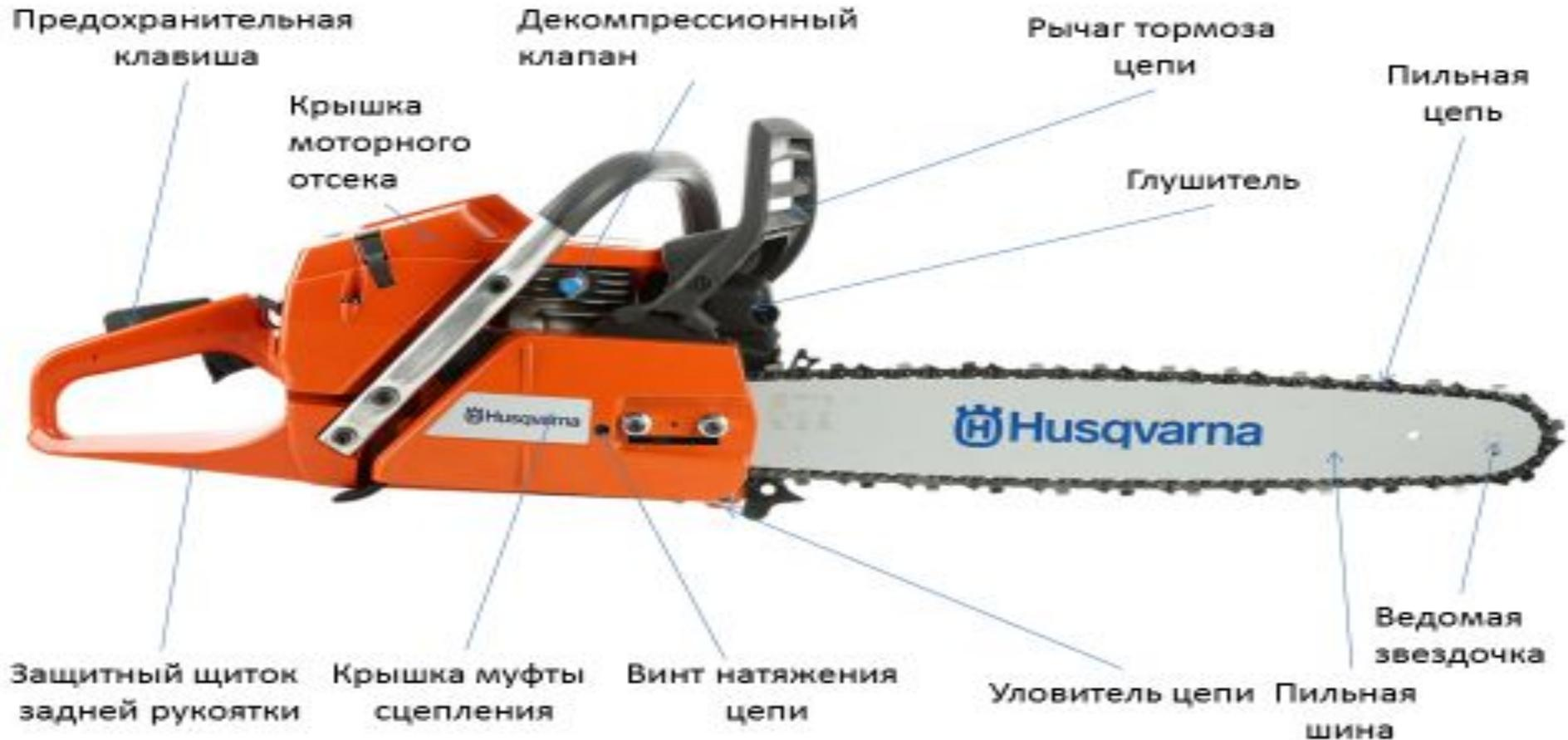
Устройство и эксплуатация бензопил
