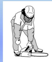
После первых вспышек нажать привод воздушной заслонки (открыть заслонку) и повторить запуск
