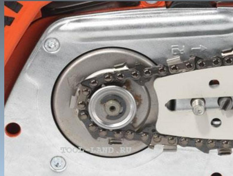
Пильная гарнитура включает в себя ведущую звездочку, цепь, шину, соответствующие друг другу, а также чехол для шины
