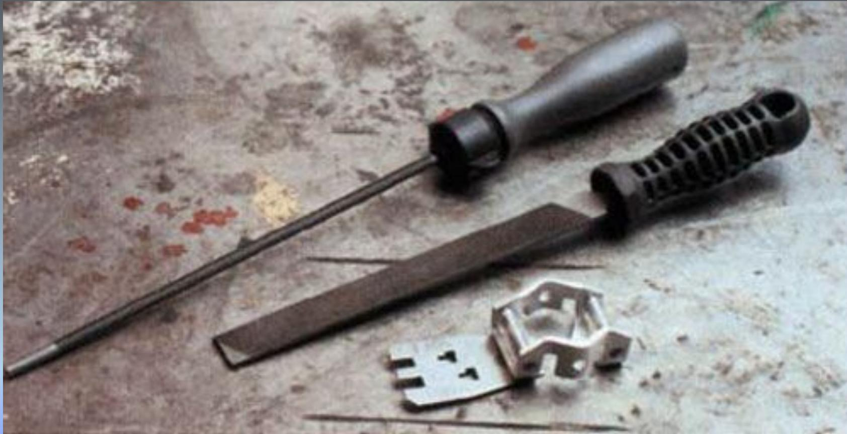
Напильник с приспособлением для заточки с роликами
