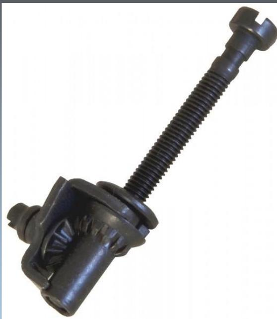
Служит для регулировки натяжения цепи. Для этого необходимо затянуть гайки крепления пильного полотна рукой. После этого натянуть цепь с помощью универсального («бензорезного») ключа. Для этого следует повернуть механизм регулировки цепи по часовой стрелке. Цепь следует натягивать до тех пор, пока она не будет плотно прилегать к нижней стороне пильного полотна.
