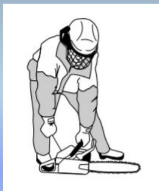
Медленно вытянуть стартер до сопротивления, затем потянуть шнур резким движением до первых вспышек в цилиндре
