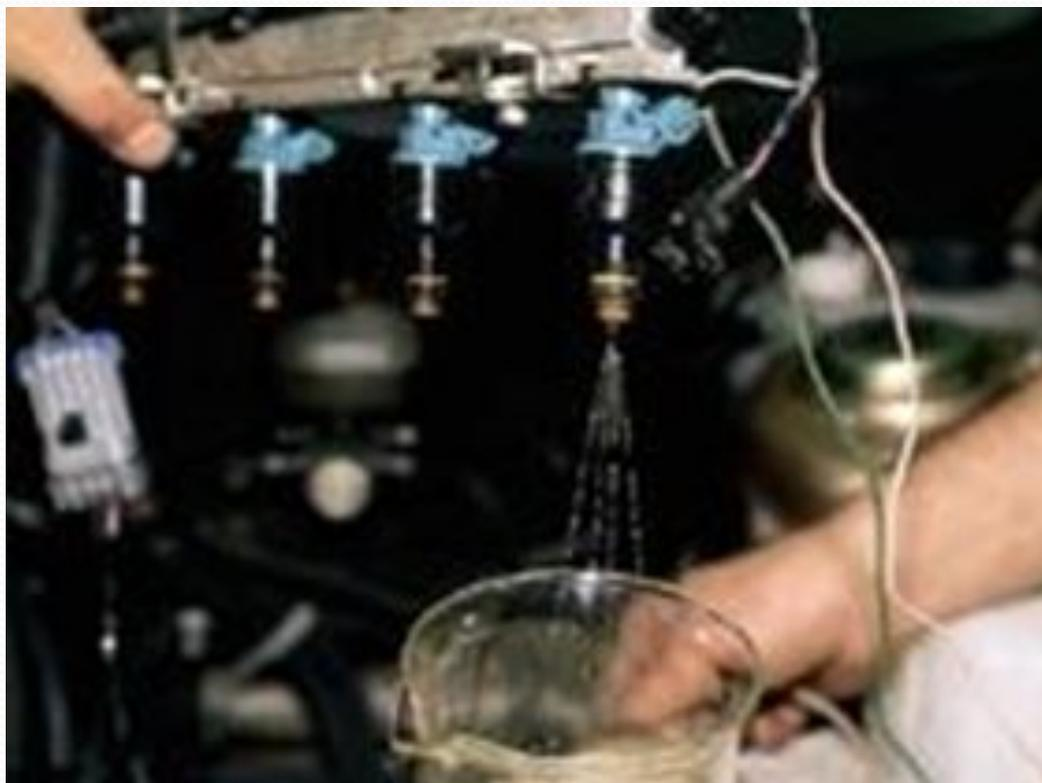
Если у какой-то форсунки не соответствует норме электрическое сопротивление, факел распыленного топлива отличается по форме от остальных, нет характерных четырех струй, количество топлива явно меньше, чем у других, то форсунку лучше заменить. Снимают форсунку (инжектор) с рампы одинаково у двигателей 2111 и 2115 (показано для 2115)
