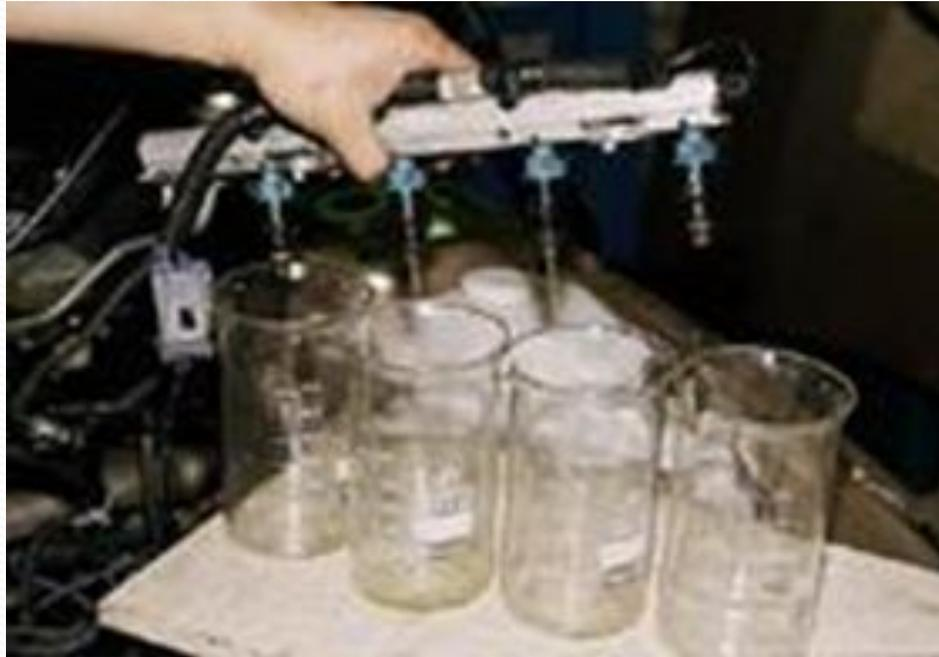
Подсоединив топливные трубки к рампе, соединяем электрический разъем жгута форсунок. Расположив под форсунками колбы, прокручиваем двигатель стартером.
