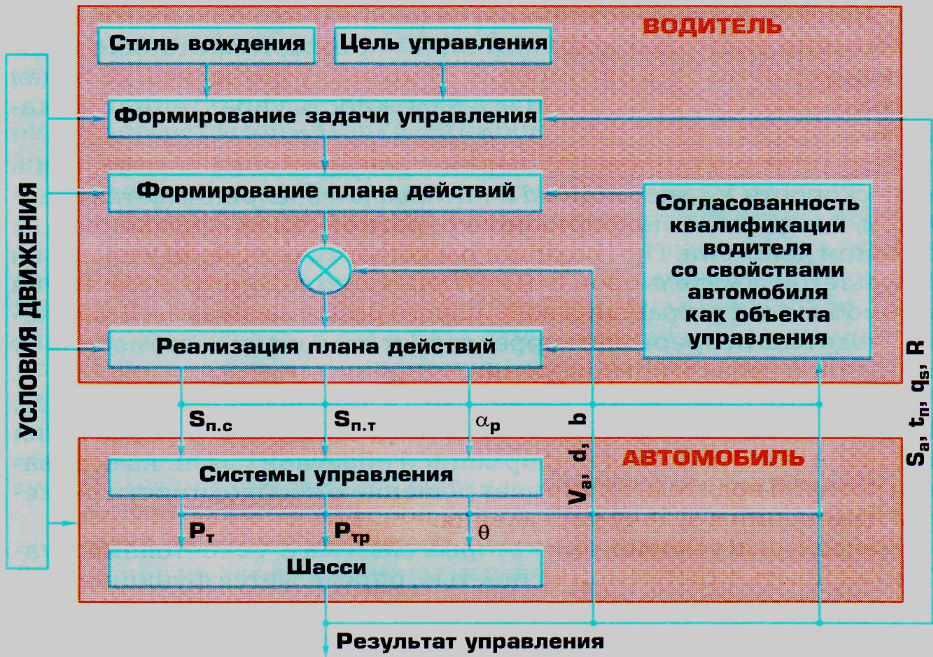
Рис. В. 2. Структура схемы системы водитель—автомобиль
