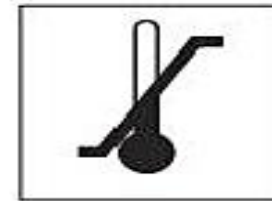
M3 05 Указывает на диапазон температур, при которых следует хранить груз или манипулировать им
