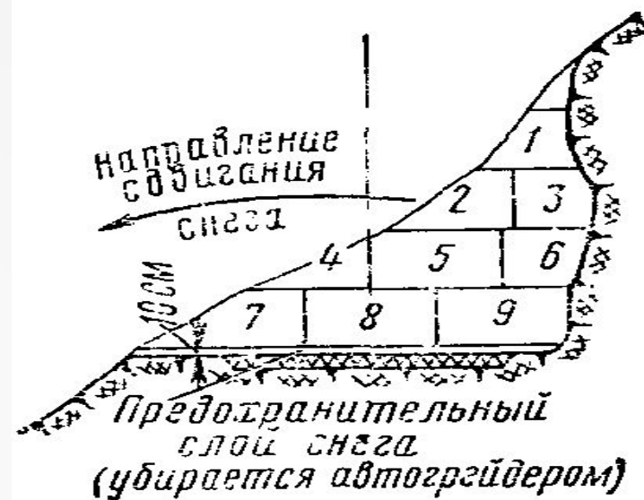
Очистка дороги в горных условиях со сбрасыванием снега под откос
