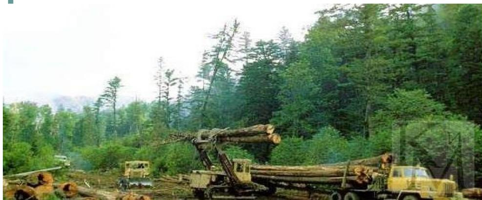
...Могучая стальная «рука» тянется к дереву, обнимает ствол, и за какие-то секунды он срезан под корень. После этого пошла трудиться-крутиться, словно в огромной карандашной точилке, желваки-лезвия, избавляя ствол от веток, превращая его в бревно и тут же разрезая на заготовки нужного размера. В это время другая «рука» тянется к бревнам, сгребает их в охапку и грузит в контейнер. Одно бревнышко закатилось в кусты, но «пальцы руки» его оттуда ловко извлекли и аккуратно положили в общую кучу.
