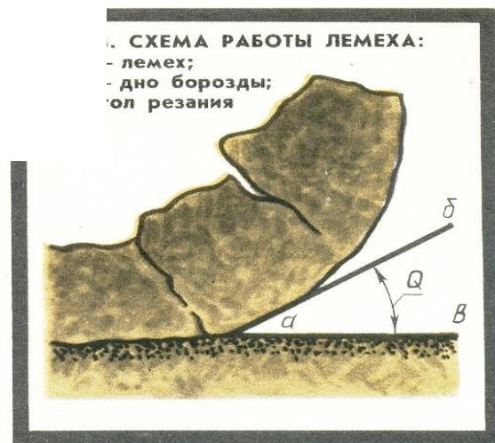
РИС. 5. ТЕХНОЛОГИЯ ПОВОРОТА ПАХОТНОГО СЛОЯ ПЛУГОМ С ВИНТОВЫМ ОТВАЛОМ
