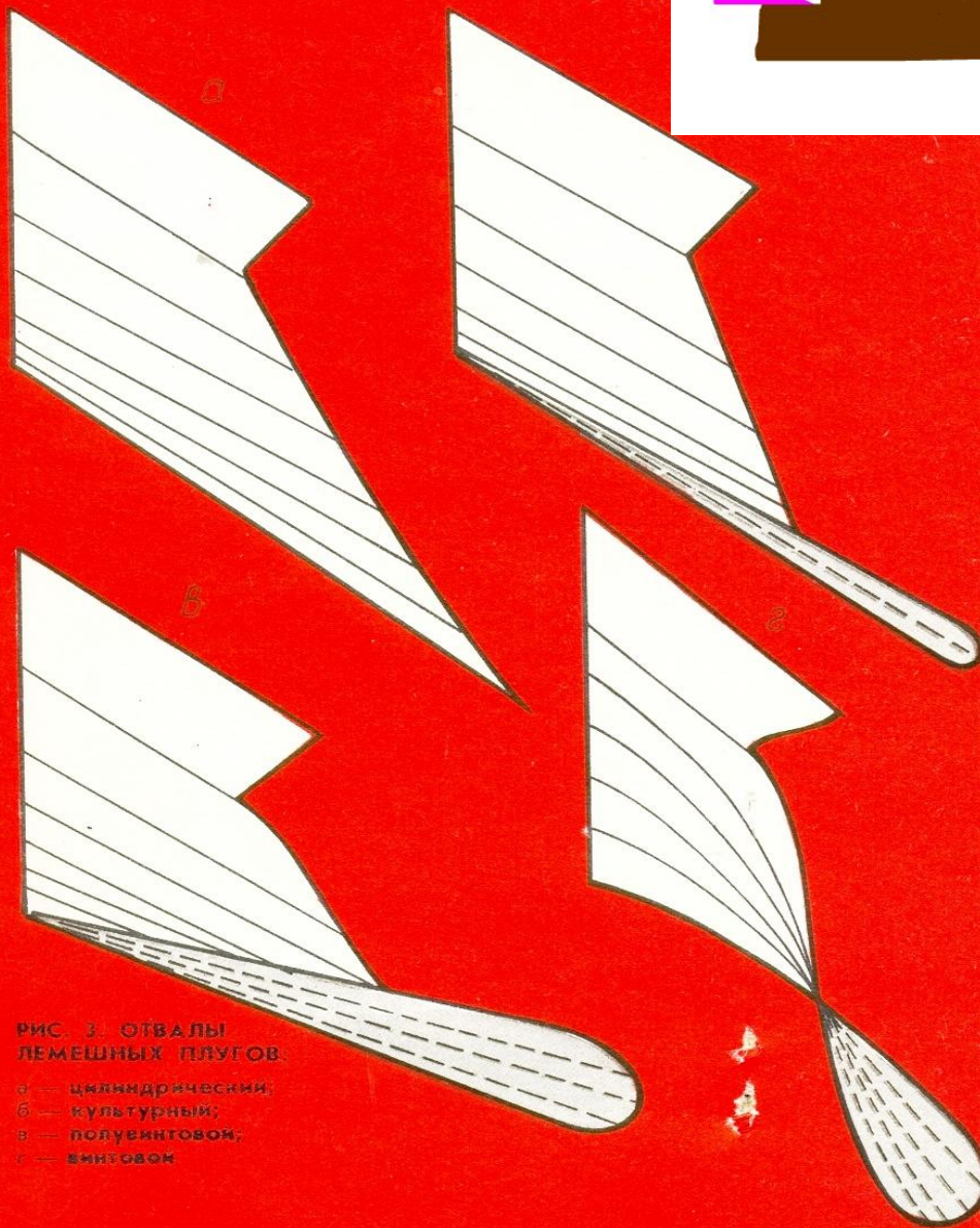
РИС. 5. ТЕХНОЛОГИЯ ПОВОРОТА ПАХОТНОГО СЛОЯ ПЛУГОМ С ВИНТОВЫМ ОТВАЛОМ
