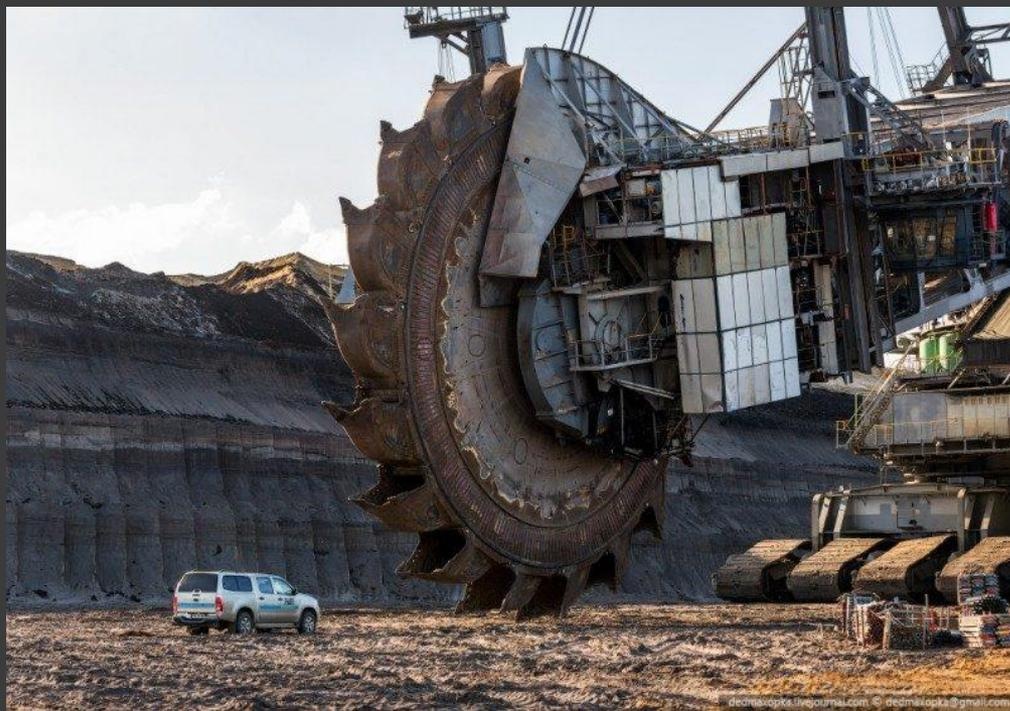
диаметр роторных колёс — до 18 м
