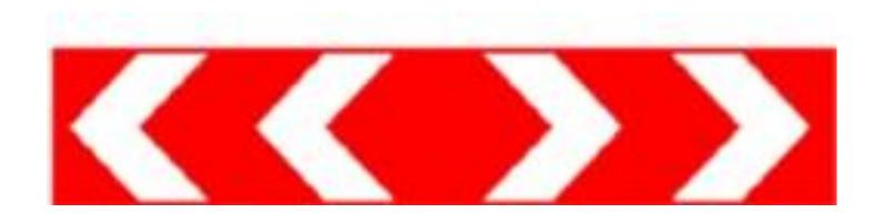
Направления движения на Т-образном перекрёстке или разветвлении дорог. Направления объезда ремонтируемого участка дороги.
