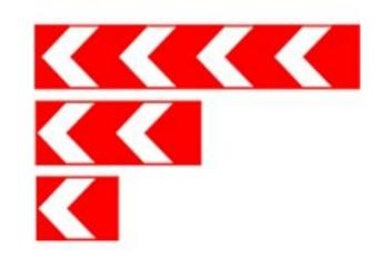
Направление движения на закруглении дороги малого радиуса с ограниченной видимостью. Направление объезда ремонтируемого участка дороги.
