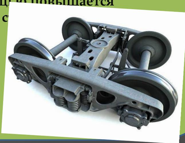
**Тележка грузового вагона обязательно состоит из следующих частей: колесные пара, боковая рама, надрессорная балка, пружины подвижные, тормозной башмак.**
